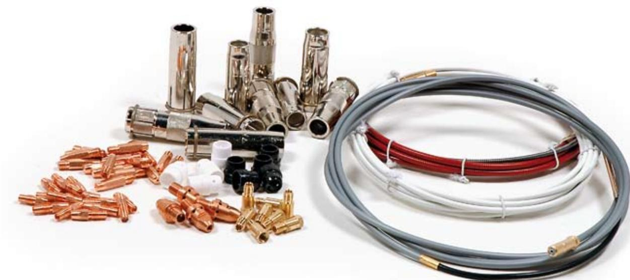
Les gaines Kemppi sont à la fois robustes et durables. La spirale robuste et rigide soutient parfaitement le fil d'apport et l'empêche de se courber exagérément lors de son passage dans la gaine de fil. La couleur des gaines de fil et celle des galets du mécanisme de dévidage sont identiques pour permettre de distinguer la correspondance -fil d'apport/diamètre-. Exemple, Pour une gaine rouge destinée à un fil d'acier/diamètre 1 -1.2, les galets de dévidage seront rouges également. Ces gaines
