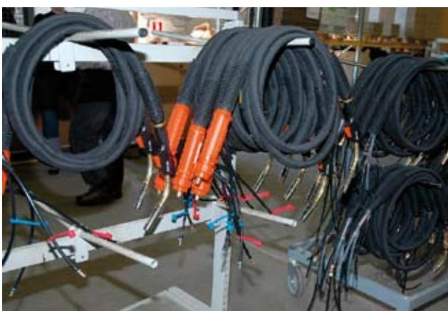
Chaque année, l'usine de Kalkkinen produit une quantité importante de torches MIG et TIG refroidies par air ou par liquide, ainsi que des centaines de kilomètres de câble.
