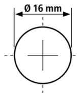
Bohrung Ø 16 mm
