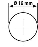
Bohrung Ø 16 mm
