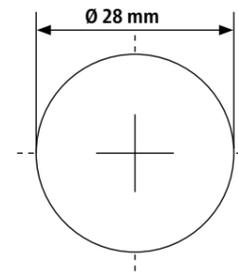
Bohrung Ø 28 mm
