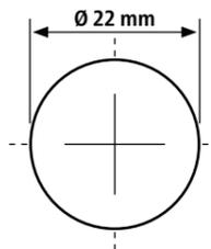
Bohrung Ø 22 mm
