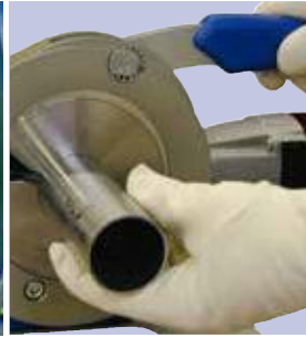
Schnellwechselsystem für Werkzeuge, Spannschalen und Rohre
