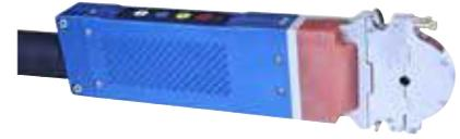
OW 12 mit schmaler Spannkassette (Typ "A")
