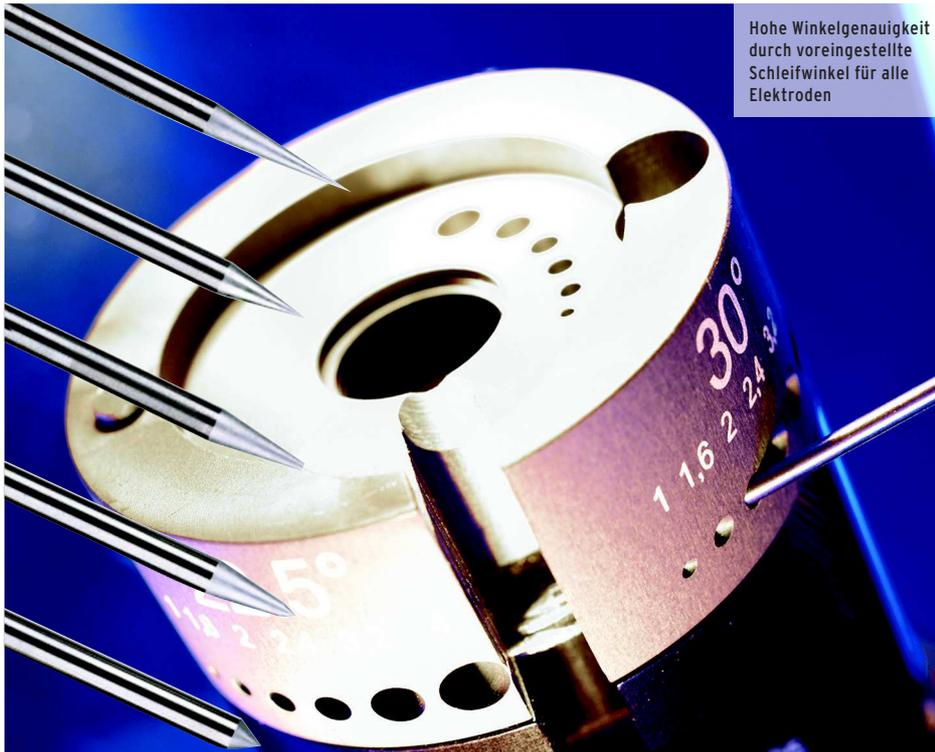
Hohe Winkelgenauigkeit durch voreingestellte Schleifwinkel für alle Elektroden
