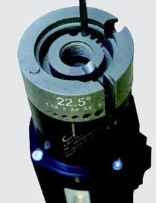
Elektroden ablängen (z.B. mit ESG MAX)
